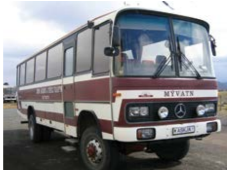
Myvatn alueelta löytyi oikea herkkipala! Jon Arni & Gisli Rafn (nykyään Myvatn tours). Huomaa sisäänkäynnin rappuset, etumaski ja lamput, jotka sopivat myös uudempiin MB LP-malleihin. Pusku-reiden valosarja on puolestaan Mercedes-Benzin suuremmasta SK-kuorma-autosarjasta. Aksja on retkikohde Dyngfjöllin alueella.
